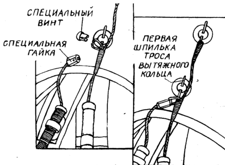
Рис. 7 Монтаж петли страхующего прибора под первую шпильку вытяжного кольца
