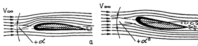
Рис. 199 Картина обтекания профиля крыла в прямом и перевернутом полете
