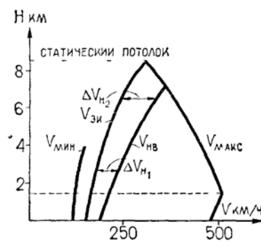
Рис. 87 Изменение характерных скоростей горизонтального полета с подъемом на высоту самолета с поршневой силовой установкой
